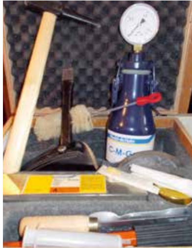
Das (anerkannte) „Maß aller Dinge“ in Sachen Bodenfeuchtigkeit, das CM-Messgeräteset (Calciumcarbid-Methode)
