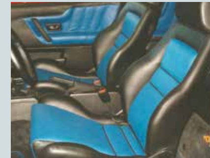
Meisterstück des Autosattlers Wilhelm Stumpf. Rennsitze mit blauschwarzem Lederbezug einschließlich Seitenverkleidungen
